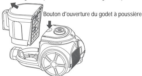
2. Retirer le couvercle du godet à poussière en localisant le bouton de déverrouillage à l'arrière du godet à poussière, au-dessus du filtre, et en appuyant sur le bouton pour retirer le couvercle. Retourner le godet à poussière pour le vider dans la poubelle.
