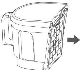
Rincer le filtre HEPA et le filtre pré-moteur à l'eau tiède.
