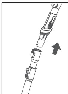
**Étape 2 :** Raccorder la lance métallique télescopique au tuyau. Fixer la lance télescopique au tuyau au niveau du coude en poussant les deux éléments ensemble jusqu'à ce qu'un clic audible se fasse entendre.
