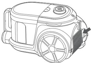
Retirer le godet à poussière de l'aspirateur et sortir le filtre pré-moteur.
