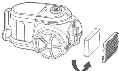
Tapoter le filtre au-dessus de la poubelle pour éliminer la poussière et les débris extérieurs.
