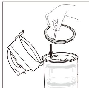
Réinstallez le filtre pré-moteur.
