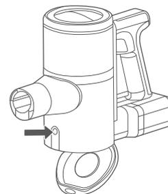
2. Premere il pulsante di rilascio del contenitore della polvere per rimuovere il manico del componente.
