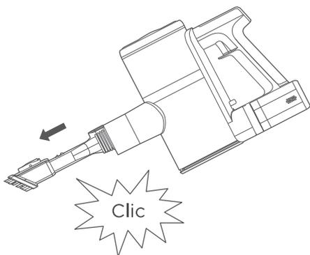
3. Empuje el cabezal del cepillo del accesorio dos en uno hacia adelante, y cuando oiga un "clic", estará fijado. Puede limpiar zonas difíciles de alcanzar, como muebles, estanterías y cortinas.
