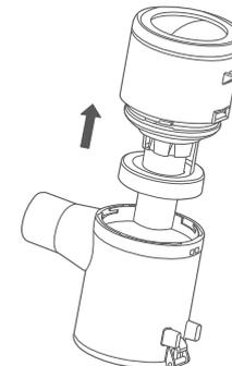
4. Drehen und entfernen Sie das Zyklonen-Element und nehmen Sie dann den Filter für die Reinigung heraus.
