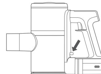
3. Ruotare il coperchio del motore per rimuovere il contenitore della polvere.
