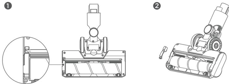
3. Nehmen Sie die Rollbürste aus der Halterung und reinigen Sie die Bürste.
