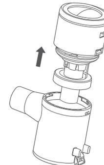
4. Tourner et retirer le composant du cône du cyclone, puis sortir le filtre en coton pour le nettoyer.
