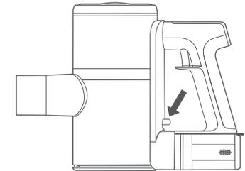
3. Tourner le composant du couvercle du moteur pour retirer le composant du bac à poussière.
