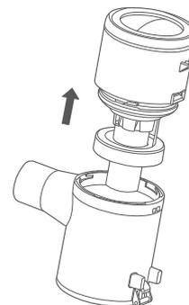
4. Ruotare e rimuovere il cono del ciclone ed estrarre il tessuto filtrante per la pulizia.
