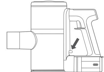
3. Drehen Sie den Motor, um den Staubbehälter abzunehmen.
