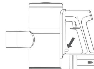
3. Gire la cubierta del motor para retirar el depósito de polvo.
